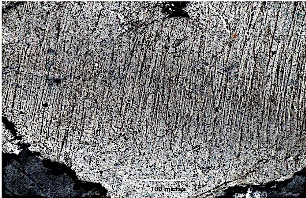
Fig. 18b. Múltiples conjuntos de PDF en un grano de cuarzo procedente de un clasto de cuarcita de Bámbola (muestra PDFKS2 BA-B de la fig. 3).
