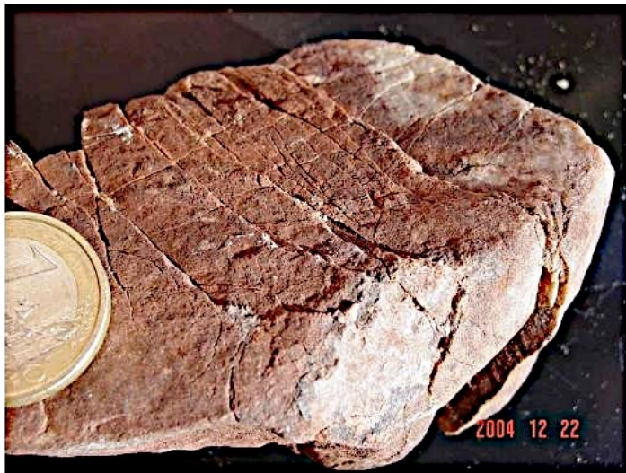
Fig. 29. Clasto de Buntsandstein con marcadas fracturas rotacionales.
