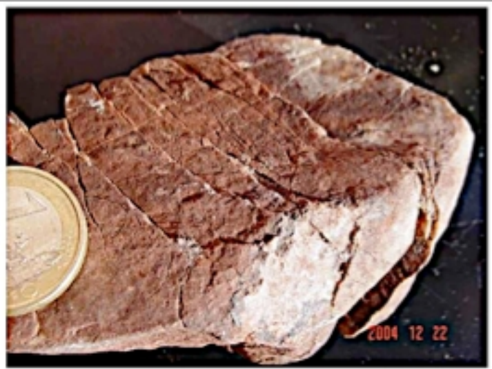
Fig. 29. Clasto de Buntsandstein con marcadas fracturas rotacionales.
