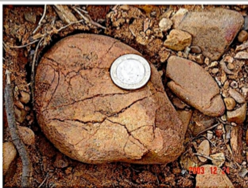
Fig. 37. Clasto de cuarcita de Bámbola intensamente fracturado. Las fracturas irregulares observadas son incompatibles con el transporte, que habría desmenuzado la muestra, e indican una fracturación in situ bajo una elevada presión de confinamiento.
